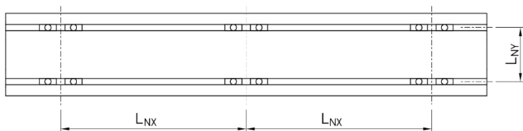
6.30. ábra : Rögzítés horonyelemekkel – HT200B
